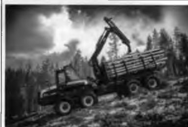
– **форвардер Elephant** – выпускается в восьми-колесном варианте. Имеет грузоподъемность 18 тонн. Оснащается манипулятором K100+. Эффективен при работе на крутых склонах, в глубоком снегу и на мягких грунтах, а также при увеличенных расстояниях трелевки.
