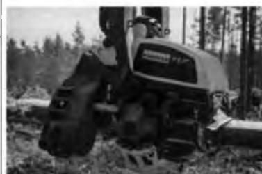
– **харвестерная головка Н7** – предназначена для интенсивного использования на харвестерах PONSSE Bear, PONSSE Ergo, PONSSE Ergo 8w, PONSSE ScorpionKing и гусеничных машины массой более 20 т для сплошных и выборочных рубок. Максимальное раскрытие передних ножей – 640 мм.
